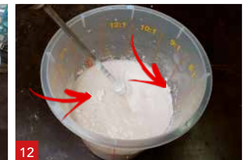
12 Mischen Sie, bis sich alle Klumpen aufgelöst haben (± 1 Minute) und eine gleichmäßige Konsistenz entstanden ist.
