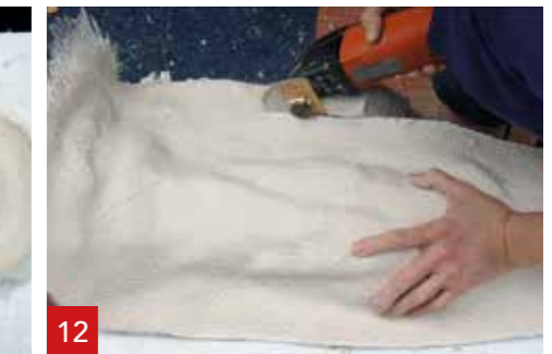
9 Drücken Sie das dreiaxsiges A1 Glasfasergewebe an. Das Gewebe last sich gut formen.
