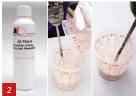
Fügen Sie 2% Thix A (im Verhältnis zum Gesamtgewicht des A1 Gemisches) zur A1 Flüssigkeit hinzu. Durch das Thix A wird das A1 Gemisch dicker.
