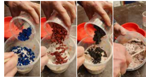
Geben Sie A1 Stücke unterschiedlicher Farbe zur angerührten A1 Masse und rühren Sie alles gut um.
