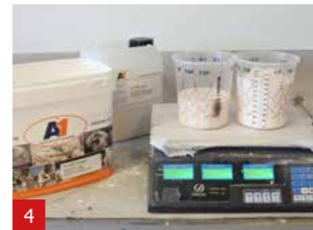
4 Wiegen Sie 1 Teil A1 Flüssigkeit und 2 Teile A1 Pulver ab und vermischen Sie beide Komponenten. Das A1 ist bereit, sobald weder Klumpen noch Luftblasen in der Mischung vorhanden sind.
