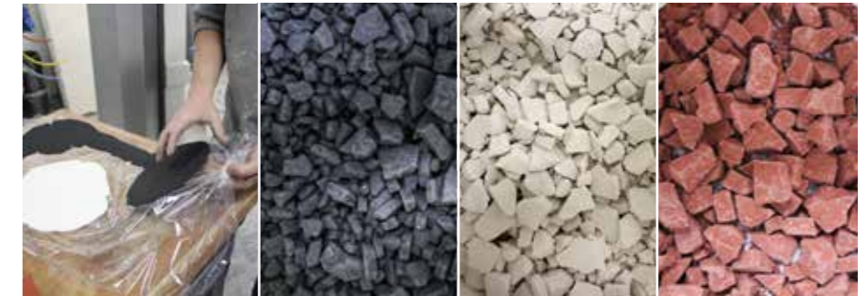
Brechen Sie diese nach dem Aushärten in unterschiedlich große Stücke.
