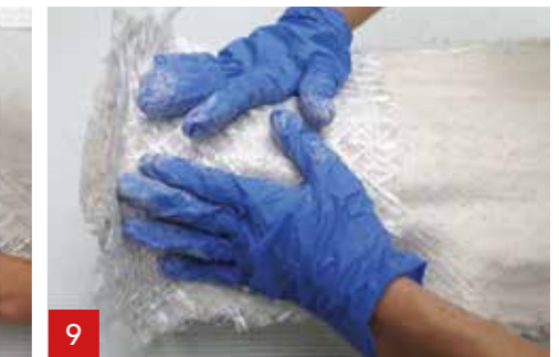
6 Legen Sie das dreiaxsiges A1 Glasfasergewebe auf die noch feuchte A1 Schicht. Fahren Sie fort, bis die gesamte Silikonform mit einer Schicht A1 und einer Lage dreiaxsigem A1 Glasfasergewebe bedeckt ist.
