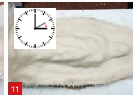
8 ...und eine 2. Lage dreiaxsiges A1 Glasfasergewebe auf die noch nasse A1 Schicht.
