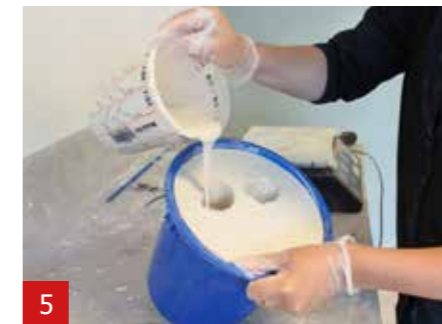
5 Gießen Sie etwas der A1 Masse vorsichtig am Rand der Öffnungen(en) entlang in die Form. Lassen Sie das A1 in alle Richtungen durch die Form laufen, um Luftschlüsse zu vermeiden. Drehen Sie den Behälter und klopfen Sie vorsichtig mit Ihren Händen dagegen, damit die Masse in alle Aussparungen läuft und Luft entweichen kann. Gießen Sie die verbleibende A1 Masse in die Form. Klopfen Sie erneut gegen den Behälter, damit sich die Masse gleichmäßig verteilt.
