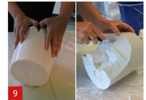
9 Das A1 ist zwar trocken, aber noch nicht vollständig ausgehärtet. Entfernen Sie das Alginat daher sehr vorsichtig von den Eingussstellen beginnend.
