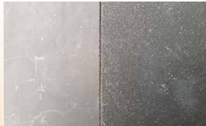
A1 Platte mit Sand unmittelbar nach dem Entformen.
