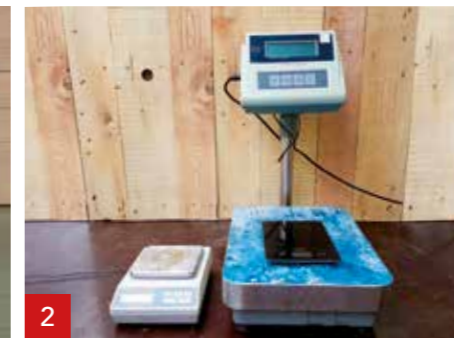
2 Sie benötigen eine Waage zum Abwiegen der A1 Flüssigkeit und des A1 Pulvers.
