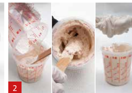
Fügen Sie dem A1 Gemisch so viel ATP Pulver hinzu, wie benötigt. Mischen Sie alles gut, bis keine Klumpen mehr vorhanden sind. Die Textur der A1 Masse sollte einer Paste oder Spachtelmasse ähneln.
