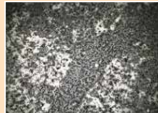
Vergrößerte Abbildung von A1 Platten mit A1 Sealer nach 4 Jahren auf der Sonnenseite.
