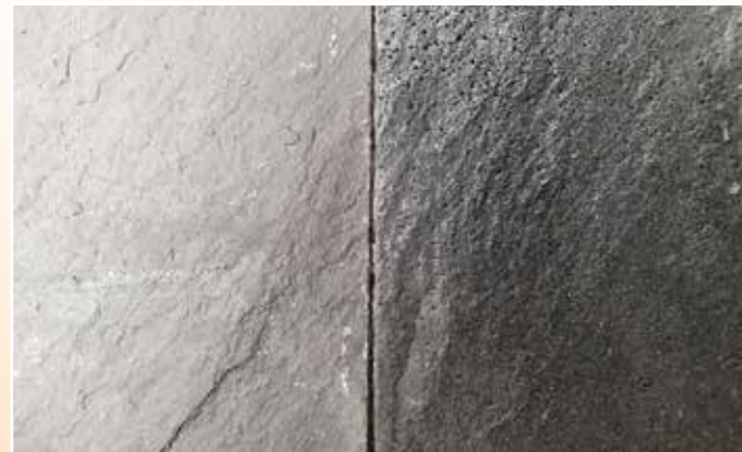
A1 Platte unmittelbar nach dem Entformen.
