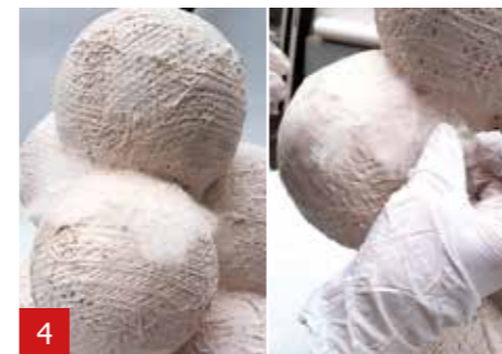
Drücken Sie die kleinen Stückchen des Glasvlieses in das A1. Die Stückchen des Glasvlieses müssen sich überlagern.
